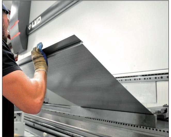
Les accessoires sont fabriqués par pliage à l'usine Artéface de Cissé (86) et SPO de l'Hermitage (35) à partir de tôles planes d'acier prélaquées provenant des mêmes types de bobines.
