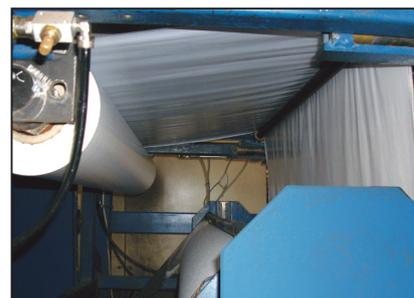
Le feutre autocollant doit être appliqué sur la tôle avant profilage, par le biais d'un dispositif de dérouleur.
