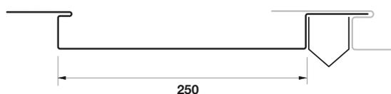
Lame de 300 mm - Épaisseur 1,00 mm - 12,04 kg/m<sup>2</sup>
