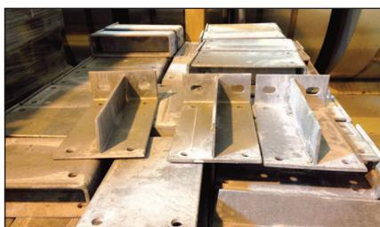
Les échantignoles assurent la liaison entre les pannes et la structure principale. Les pannes sont "suspendues" afin d'éviter la compression locale de l'âme. C'est pourquoi il y a un jeu d'environ 10 mm entre l'ossature et le profilé. Les échantignoles standards sont fabriquées dans des aciers à haute limite élastique et galvanisées à chaud. Elles sont fixées aux fermes soit par boulonnage soit par soudage. Les pannes sont attachées aux échantignoles par boulonnage.
