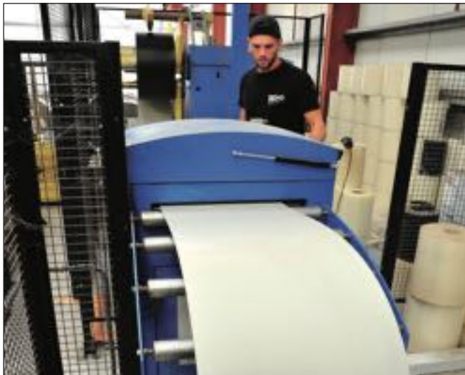
Profilage sur le site Artéface de Cissé (86).
