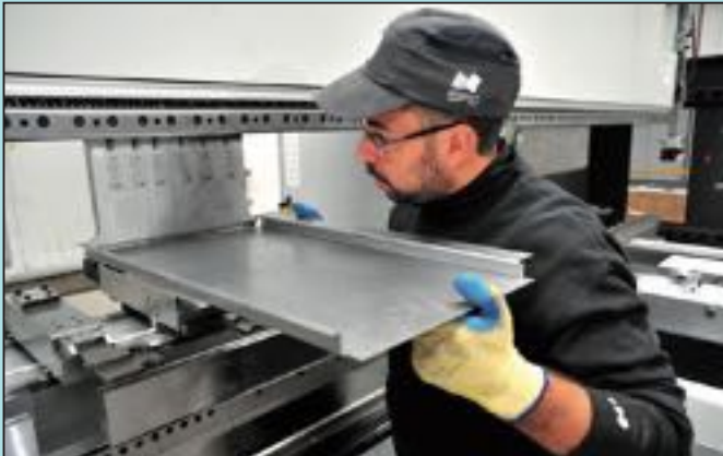
Pliage d'une lame Iroise
