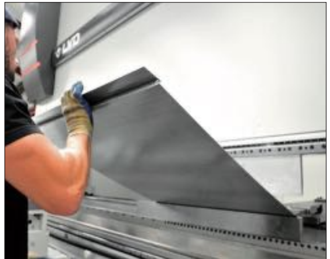
Les accessoires sont fabriqués par pliage à l'usine Artéface de Cissé (86) et SPO de l'Hermitage (35) à partir de tôles planes acier prélaquées provenant des mêmes types de bobines.
